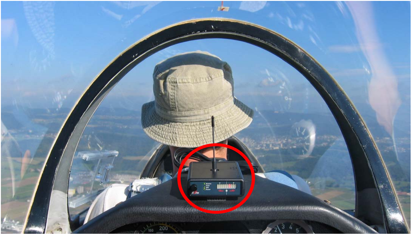
Intensiv leuchtende LED zeigen gefährlichen Verkehr an. Richtung und Gefährdung werden dargestellt. Gleichzeitig ertönt ein Signal.
